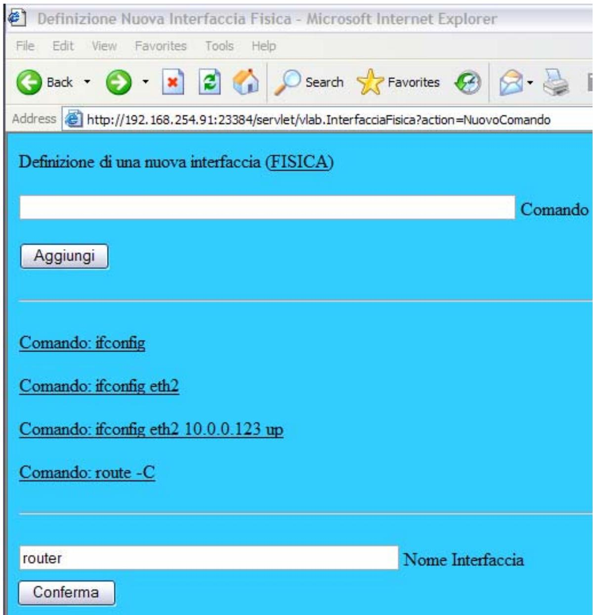
Fig. 4.2 – On-lab. Creazione di un'interfaccia fisica.
